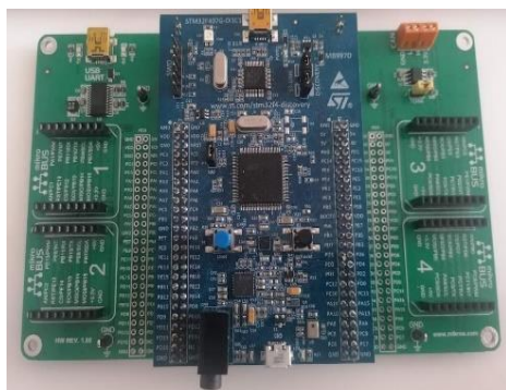
Sl. 5. STM32F4 discovery shield sa STM32F407VG razvojnim sistemom
